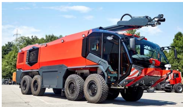
Flughafenlöschfahrzeug PANTHER 8x8 mit N110 und FOAMATIC E
